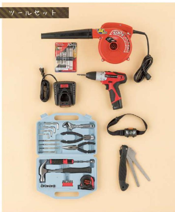
DIYなどの趣味の工作に便利なツールセット。ドリルドライバー:モーター電圧10.8V。回転数(低速)0~400min-1(高速)0~1300min-1。最大締付トルク約15Nm(ドリルポジション、低速モード)。クラッチ1~17段、クラッチ作動0.5~8.0Nm。チャック把握径1.5~10mm。充電時間約40分。バッテリー容量約1500mAh。ハンディブLOWER:単相交流100V(50/60HZ)。風量2.3m<sup>3</sup>/min、風速0~76m/s。コードの長さ約2m。本体質量1.7kg。ヘッドライト:防水保護等級4(IPX4)。単4乾電池3本使用(別売)。
